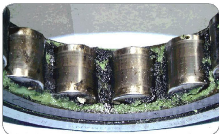
Deterioramento del lubrificante causato da correnti di scariche elettriche
