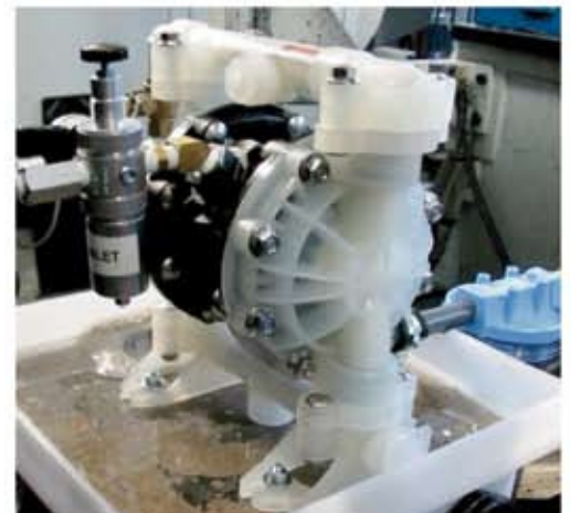
Pompa a doppio effetto autoadescante a funzionamento pneumatico
