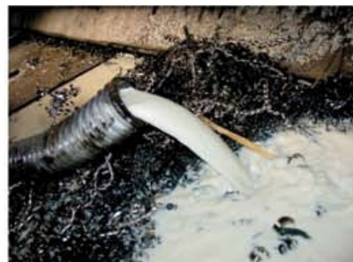
Emulsione in uscita dal depuratore - disoleatore MIXI
