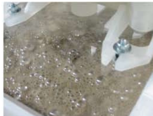
Vasca separatrice durante il funzionamento del depuratore-disoleatore MIXI
